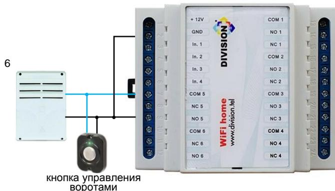
Рисунок 4 – Схема подключения блока управления воротами (6) к выходам модуля WiFi home
